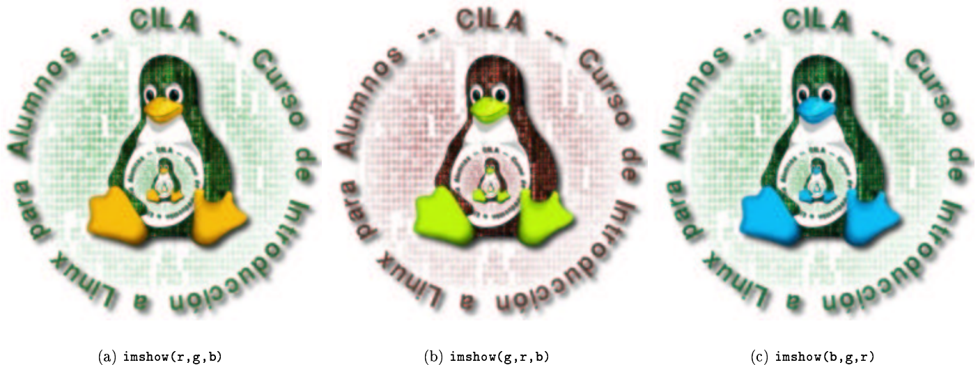
Figura 14.7: Los colores de la imagen vienen representados por sus componentes RGB. Si se invierten, los colores cambian.
